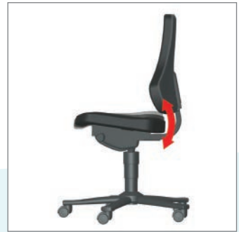
Höheneinstellung der Rückenlehne und Neigung der Sitzfläche
